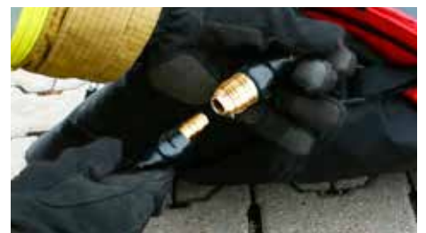
Druckluft-Kupplung: weiblich für Schlauchdurchmesser 9mm; Nennweite 7,2mm
