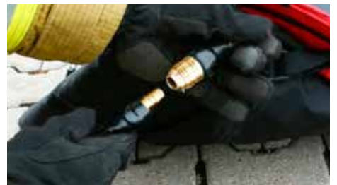
Druckluft-Kupplung; weiblich für Schlauchdurchmesser 9mm; Nennweite 7,2mm
