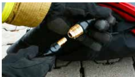
Druckluft-Kupplung: weiblich für Schlauchdurchmesser 9mm; Nennweite 7,2mm
